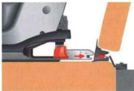
Альтернативой штатным ремням безопасности при фиксации детского удерживающего устройства является система Isofix. Она представляет собой жесткое крепление кресла к кузову автомобиля. Благодаря этому обеспечивается лучшая защита ребенка.
