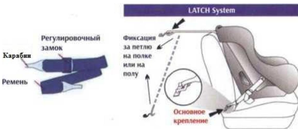
Главная особенность крепления Latch (американский стандарт) по сравнению с Isofix заключается в отсутствии металлической рамы и кронштейнов в конструкции кресла, что значительно облегчает его вес. Крепление осуществляется при помощи прочных ремней, которые фиксируются карабинами к скобам Latch на заднем сиденье автомобиля.
